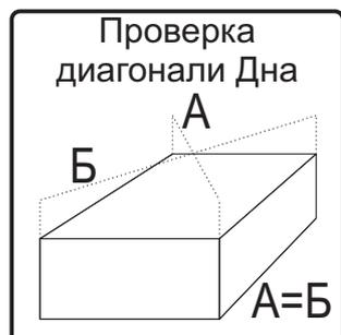
4. Перед закреплением дна №8 необходимо выровнять диагональ при помощи рулетки, после чего закрепить дно гвоздями, соединив их профилем №9. Закрепите гвоздями подпятники на царги и щиты.
